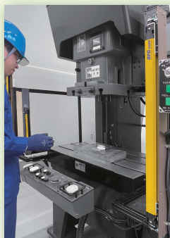
手を安全領域に戻すとスライドが自動で起動し、加工を開始します
